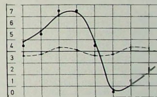
Bild 2. PCM-Prinzip: gestrichelte Linie ergibt Mittelwert der abgetasteten Amplitude
